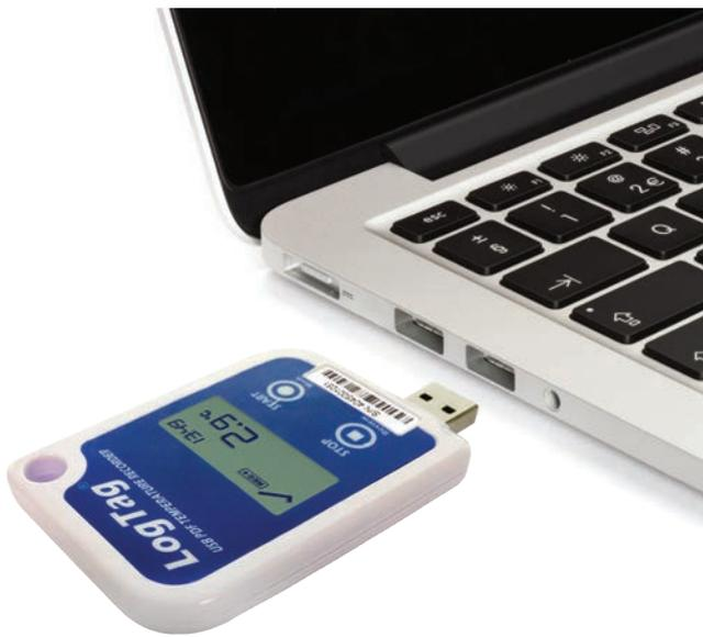
Der LogTag® UTRID-16 besitzt ein LCD Display, über das aktuelle und vergangenen Temperatur- und Alarmstatistiken direkt am Gerät abgerufen werden können. Auf dem Display werden Aufnahmezustand, letzte aufgezeichnete Temperatur und Alarmstatus von bis zu sechs vom Benutzer konfigurierbaren Alarmkonditionen angezeigt, sowie die Dauer von Temperaturabweichungen.
